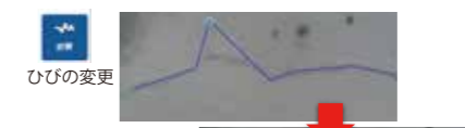
ひびの結合 指定した2点間が入る距離を入力し端点を結合
